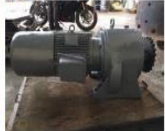
◎馬達減速機漏油拆開更換破損油封並添新油
