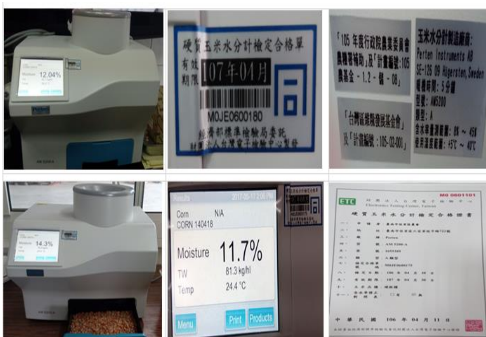
補助地方農會硬質玉米水份測定計
